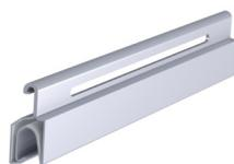
Das doppelwandige, rollgeformte Aluminium-Rollladenprofil mit Licht- und Lüftungsschlitzen (9,9 x 7,8 mm). Der arretierte Behang ist durch die gerade Profildesign im geschlossenen Zustand für eine ästhetische Fassadengestaltung geeignet.
