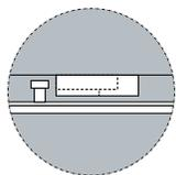
Aushebelsicherung AhS mit Stahl-Pilzkopfzapfen die in Stahl-Schließplatten einriegeln.
