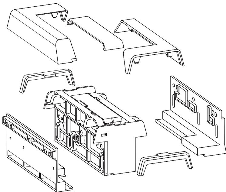
Die umfangreichen Ausgleichswinkel mit ihren integrierten Dichtungen sorgen für sicheren Sitz und perfekte Anpassung an das Profil. Das profilunabhängige Grundlager mit den weißen oder schwarzen Abdeckkappen wird durch das Adapterset an die Profilsysteme angepaßt.
