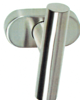
Hanna Edelstahl-sat. Nylonunterkonstruktion Grifflänge: 86 mm mit Rastermechanik, fest/drehbar gelagert,
